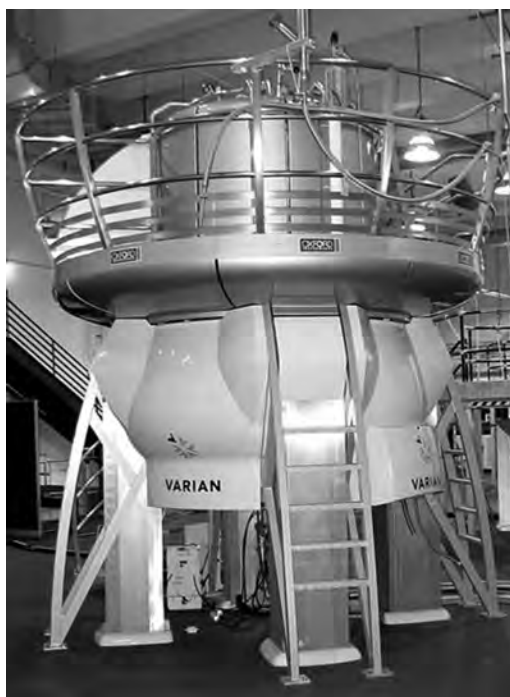
Рис. 41. Магнит спектрометра ЯМР VARIAN с рабочей частотой 800 МГц
